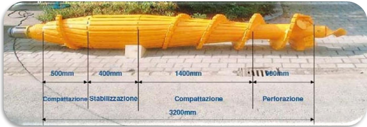
Fig. 2: Tipico utensile di perforazione utilizzato.
